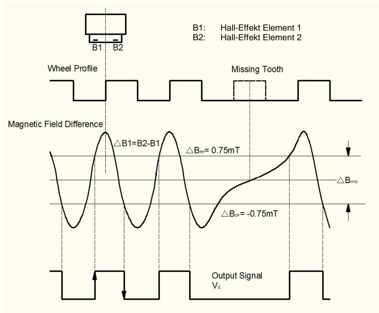
Einschaltpunkt:  $B_2 - B_1 < \Delta B_{OP}$  schaltet den Ausgang ein ( $V_Q = \text{LOW}$ )
