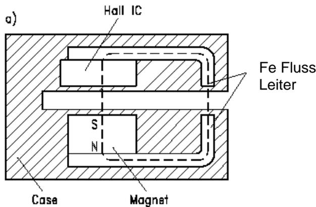
a) Magnetischer Fluss durch den Halleffekt-Schalter ohne Fe-Blech im Luftspalt
