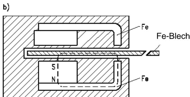
b) Magnetfluss ist kurzgeschlossen vom Fe-Blech
