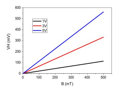
Ausgangshallspannung in Abhängigkeit vom Magnetfeld bei einer Spannung von 1 V, 3 V und 5 V an den Eingängen des Hall-Sensors
