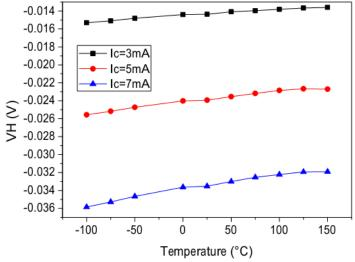
Ausgangshallspannung in Abhängigkeit von der Temperatur bei Versorgungsströmen von 3mA, 5mA und 7mA an den Eingängen des Hallsensors und bei einem Magnetfeld von 30mT
