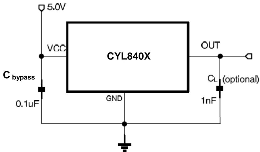
在静态状态下（即没有明显的磁场： $B=0$ ），输出 $V_{OUT}(Q)$ 等于电源电压 $V_{CC}$ 的一半，贯穿整个 $V_{CC}$ 的工作范围。垂直于封装表面的南极性磁场的存在使输出电压从静态值向电源电压方向增加。输出电压的增加量与施加的磁场的大小成正比。反之，应用北极性磁场将使输出电压从静态值下降。这种比例关系被定义为传感器的磁灵敏度， $Sens$ （ $mV/Gs$ ）。
