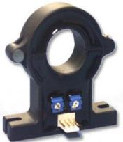
1(+): Vcc 2(G): NC (GND) 3(O): Output 4(G): GND
