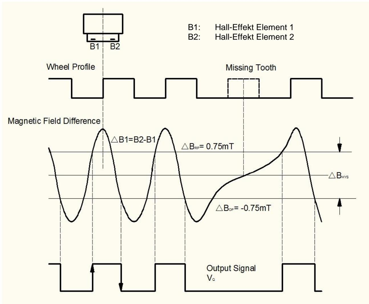
Einschaltunkt:  $B_2 - B_1 < \Delta B_{OP}$  schaltet den Ausgang ein ( $V_Q = \text{LOW}$ )
